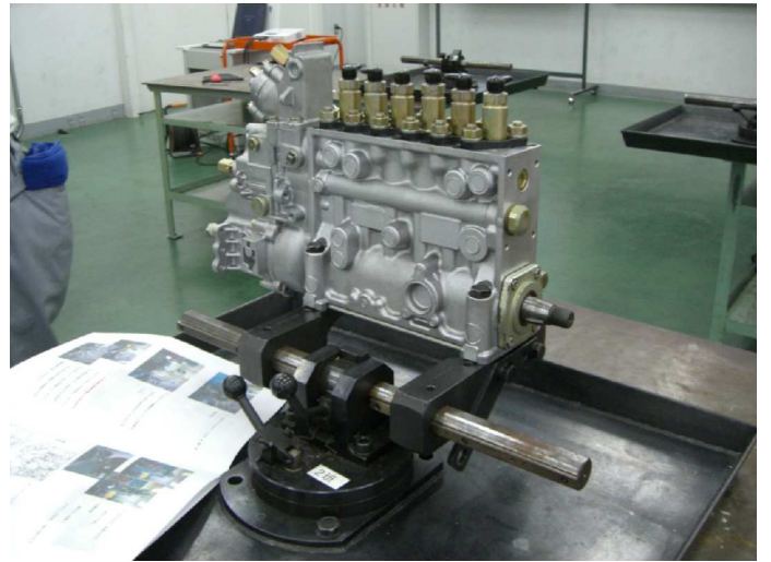
噴射ポンプ分解・組み立て実習
